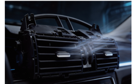
降噪材料实际应用：通过降噪材料吸收空调出风口高频气流噪声以及抑制机械噪声和结构传声。
