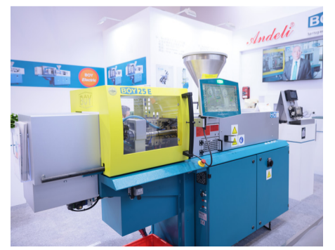
在 CHINAPLAS 2026 上，BOY 25 E 注塑机生产胰岛素药筒计量螺杆。
