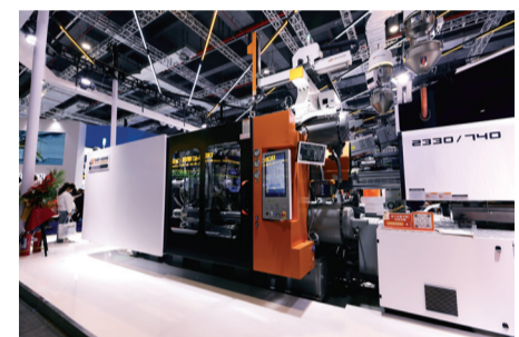
震雄在本次展会全球首发的背负式电射台多物料二板机，在现场演示生产大尺寸收纳盒。
