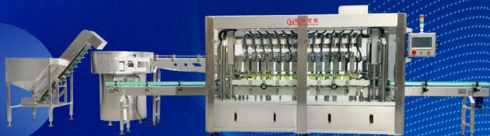
泵头盖理盖旋盖生产线
