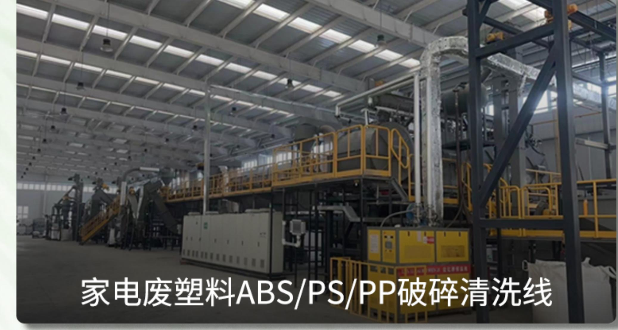
家电废塑料ABS/PS/PP破碎清洗线
