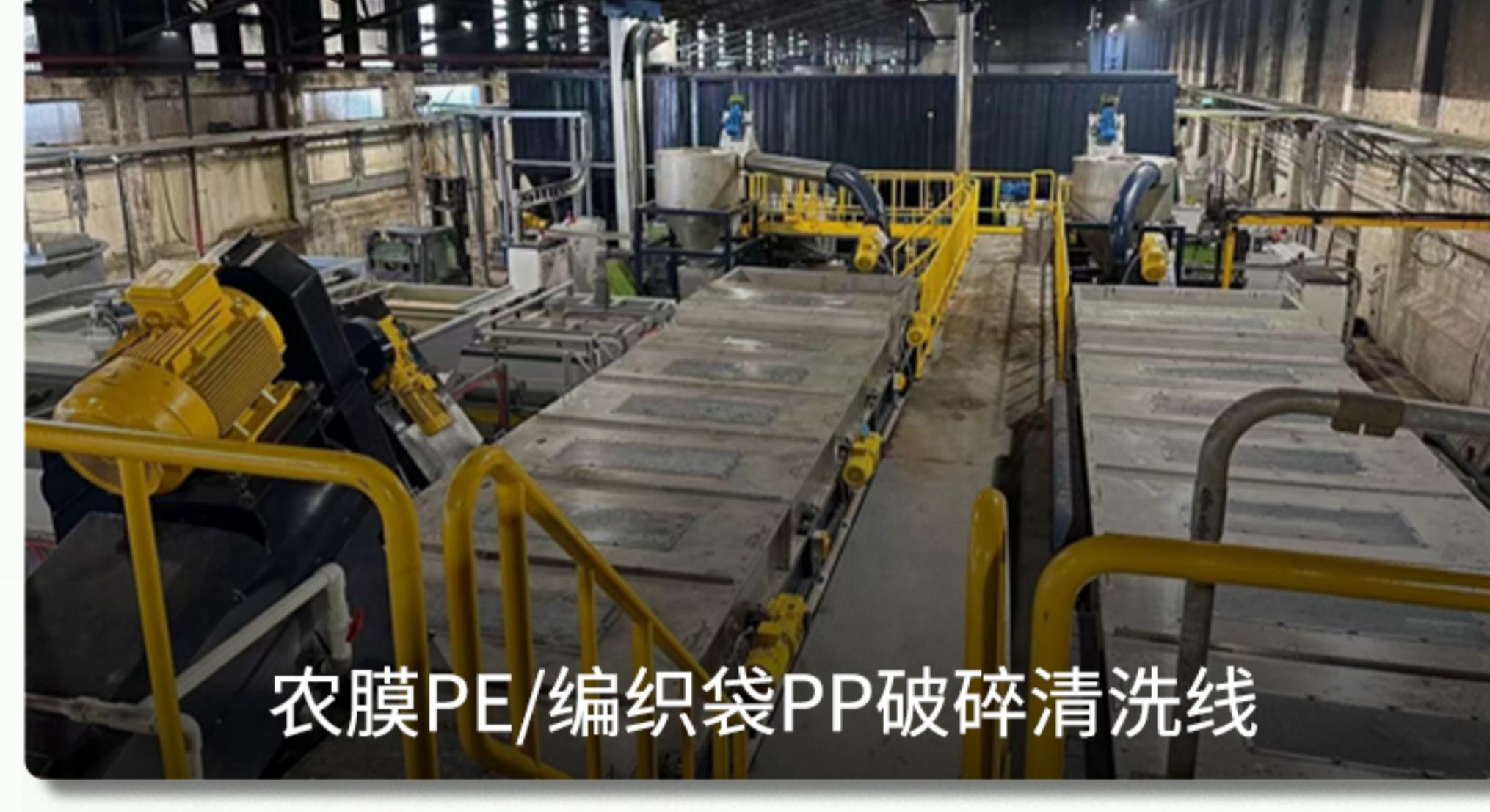
农膜PE/编织袋PP破碎清洗线
